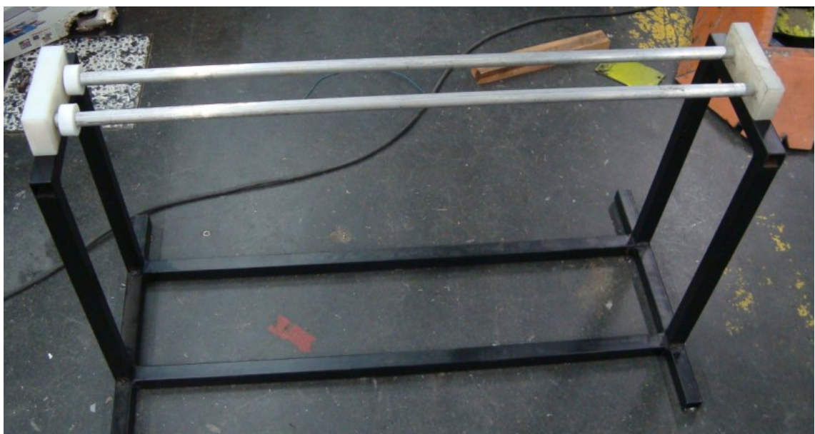
Figura 8.5: Guia Linear montada, sem o bloco
